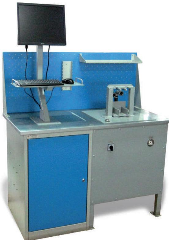
Стенд ПЭС-07 оснащен микропроцессорной платой для автоматического управления пневмомодулем.
